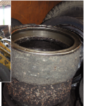
磨耗したタイヤ。金属くずとの激しい摩擦の跡がうかがえる。
