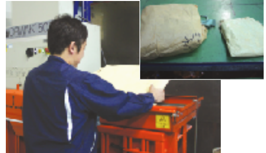
3.減容機にかける 手で折り畳むだけではかさばるので、減容機でプレスすることでペタンコにする。
