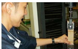
コンテナバッグの生地強度テスト中です。
